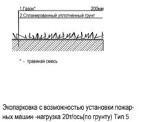
**Экотрасса с возможностью установки пожарных машин - нагрузка 20т/ос/по грунту Тип 5**
